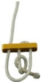
5. Joindre la corde et le coulisseau à 3 trous de la façon montrée ci-dessus.
